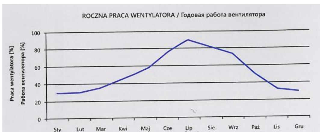
Rysunek 2 Zróżnicowane obciążenie wentylatora w całym roku kalendarzowym (Źródło: Katalog pt. „Wyposażenie budynków inwentarskich” firmy TERRAEXIM AGROIMPEX).
