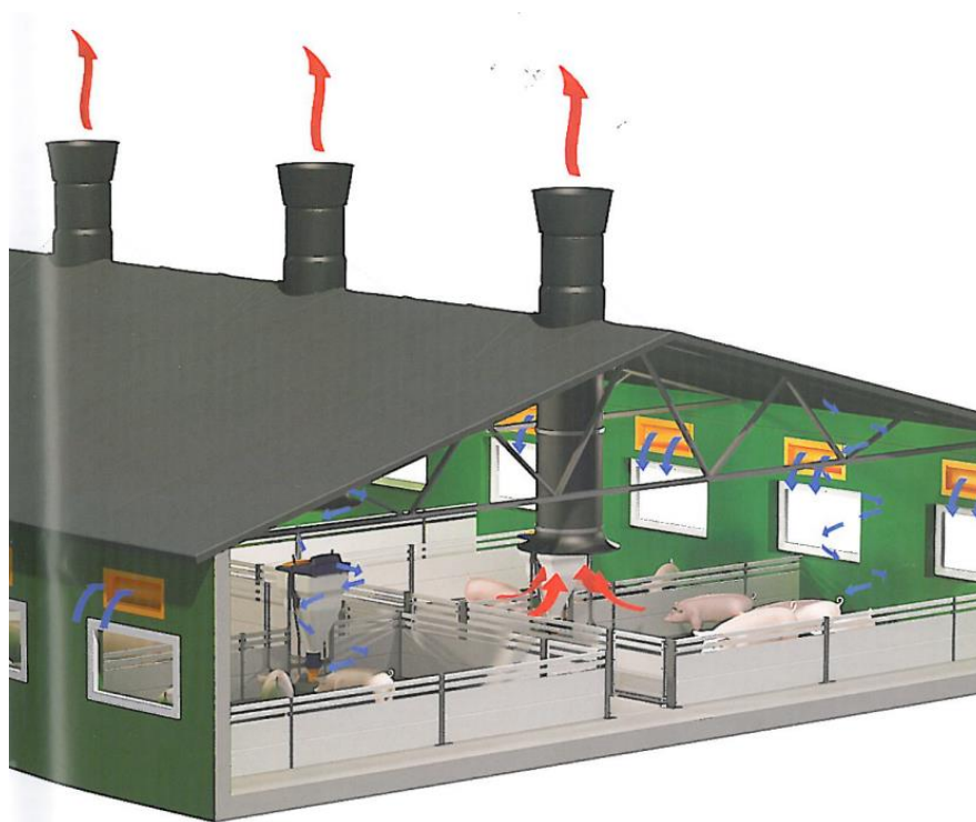
Rysunek 3 Rozwiązanie umożliwiające uzyskanie dużego „efektu kominia” (Źródło: Katalog pt. „Wyposażenie budynków inwentarskich” firmy TERRAEXIM AGROIMPEX).
